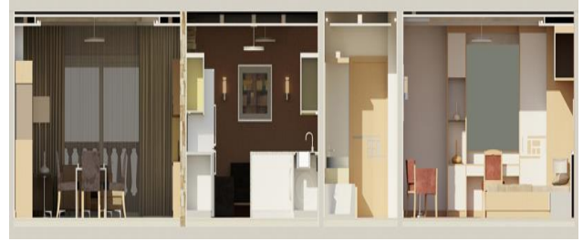
شكل (18) قطاع B-B للشقة بعد التصميم والتعديل، يمر من اليمين إلى اليسار بغرفة النوم الرئيسية والحمام والمطبخ والاستقبال. المصدر: تصميم الباحث وعمله.
